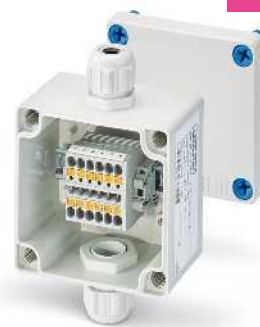
Caixa de bornes com 6 bornes de 2,5 mm 2 com tecnologia de conexão push-in
