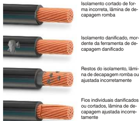
Erros de decapagem conforme DIN IEC 60352-2
